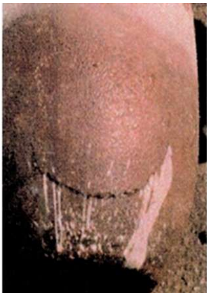
Razpoka v obliki "ščita", ki jo je povzročil ingot, zataknjen ob strani stene lonca.
