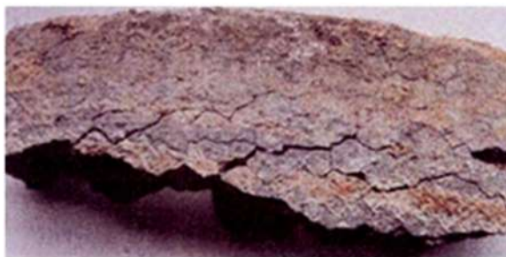
Pokanje ob zgornjem robu zaradi slabe nastavitve, ki ji sledi oksidacija.
